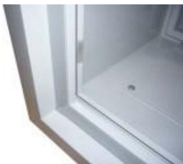
Dichtungen bei offener Tür
