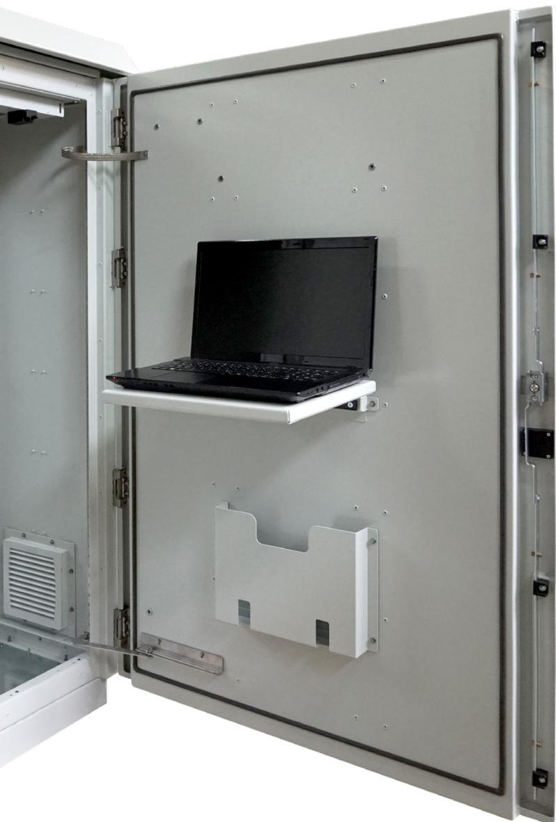
Eine PU-Schaumdichtung in Kombination mit einem einzigartigen 4-Punkt-Schließsystem sorgt für die entsprechende Komprimierung und dichtet das Gehäuse perfekt ab, sodass die Schutzart IP66 erreicht wird. Weitere Einbauten können flexibel an den vertikalen und horizontalen Systemprofilen befestigt werden. Weitere Systemprofile können Sie einfach und bequem nachbestellen und nachträglich montieren.
